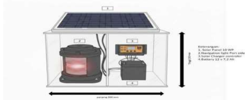
Gambar 2. Perancangan alat tampak depan
