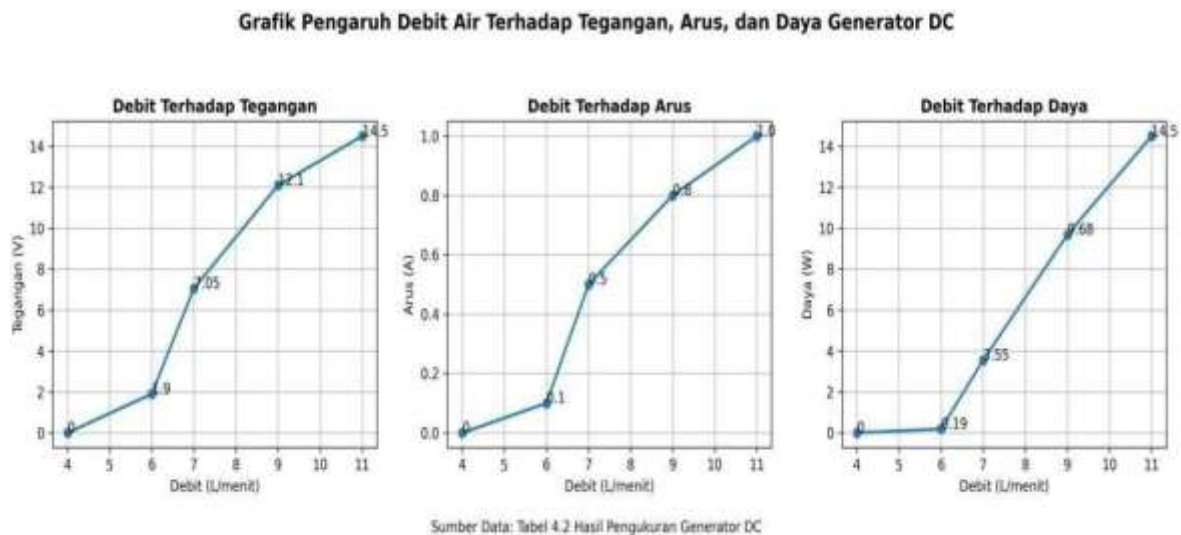
Gambar 5. Hubungan debit aliran terhadap tegangan, arus, dan daya generator
