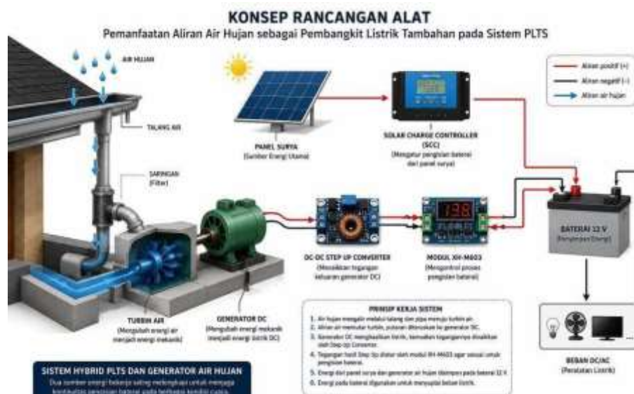
Gambar 1. Konsep rancangan sistem hybrid panel surya dan generator air hujan
