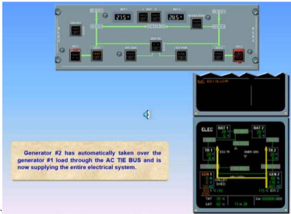
Gambar 3 Konfigurasi Setelah Kegagalan IDG 1
